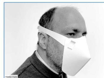
**Premier essai d'homologation** : Direction Générale de l'Armement : masques refusés: ils ne collent pas assez bien au visage. Pour justifier leur décision, les laborantins de la DGA agrémentent leur réponse d'une photo d'un des cônes pendant lamentablement devant la bouche d'un mannequin. «**Ils n'avaient pas compris que c'était un kit et qu'il fallait fixer l'attache !**»
